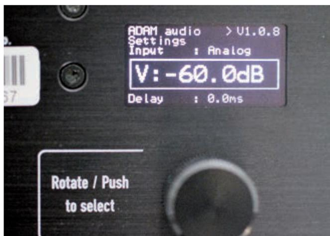
Abb. 5: Die rückseitige Lautstärkeregelung verlangt etwas Eingewöhnung – die Anpassung der Parameter kann nicht für beide Boxen synchron erfolgen
