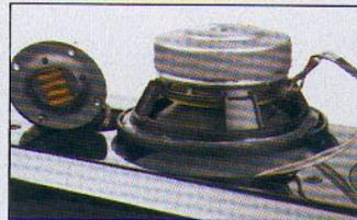
▲ Vier Schlitze öffnen den Blick auf den Air-Motion-Transformer. Ein satter Magnet prangt am Bass.
