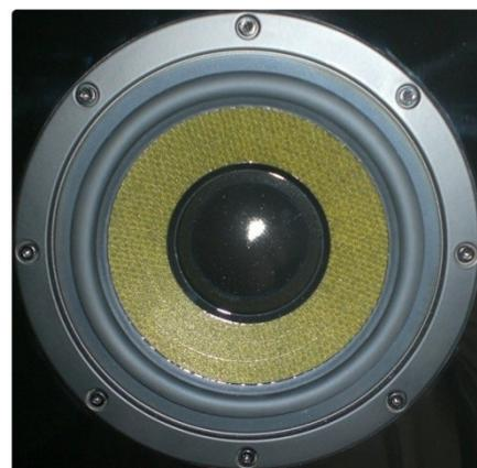
Noch ein Stück weiter unten sehen wir noch ein 7“ HexaCone-Modell mit dem Unterschied, dass diese Membran nur für die Frequenzen von 35 – 150 Hz zuständig ist. Dadurch wird vor allem eine Entlastung und Ergänzung des Tief- und Mitteltonbereiches erreicht. Mit Neodymmagneten und einer extra großen Schwing-spule wird ein enormes Volumen im Bassbereich erreicht, was laut ADAM zwar nicht im Vordergrund stehen soll, dies aber gelegentlich tut.
