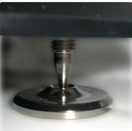
Die Spikes müssen dabei nicht im vollen Umfang durch die Öffnung in der Bodenplatte gedreht werden, sondern können zum Ausgleich von Unebenheiten im Boden beispielsweise auch drei Millimeter höher gedreht werden, hauptsache sie sitzen noch fest justiert in der jeweiligen Kontermutter.
