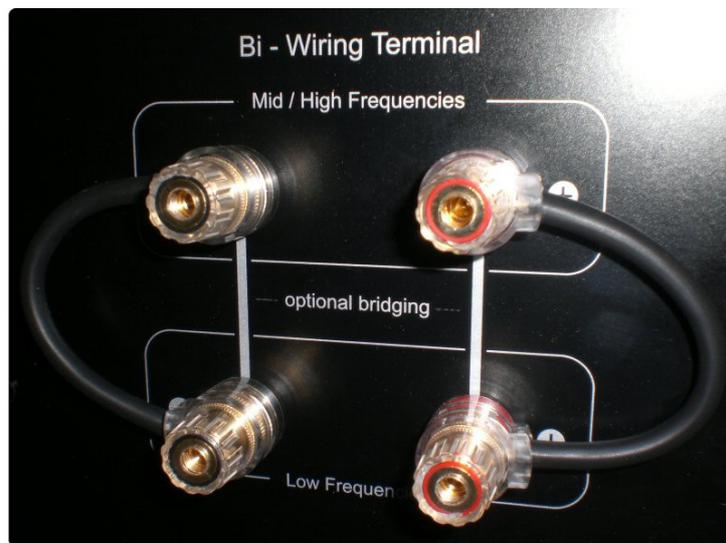
Weiter unten sticht die gewohnte Qualität der Anschluss-Terminals bei ADAM-Lautsprechern hervor. Ein hochwertiges Bi-Wiring Terminal, bestückt mit vergoldeten Kabelbrücken. Die ebenfalls vergoldeten Schraubklemmen, für den Tiefton- und Mittel-/Hochton sind sehr robust und können gerne auch mal fester als normal bedient werden. Bananas, aber auch unkonfektionierte Kabel, finden dort problemlos Platz.
