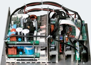
Bei einer Aktivbox erfolgt die Aufteilung der Frequenzbereiche leistungslos auf Vorverstärkerniveau durch elektronische Filter, die im Falle der Tensor Beta eine gutmütige Butterworth-Charakteristik besitzen. Die Flankensteilheit ist mit 24 Dezibel pro Oktave etwa doppelt so groß wie bei Passivboxen üblich, entsprechend schmal sind die Überlappungsbereiche zwischen den Chassis.
