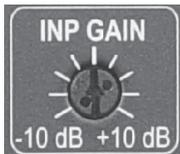
Um sich an unterschiedliche Pegel und Anschlußarten anpassen zu können ist die Spannung, bei welcher der Monitor seine maximale Lautstärke entwickelt, in einem Bereich von  $\pm 10$  dB regelbar:
