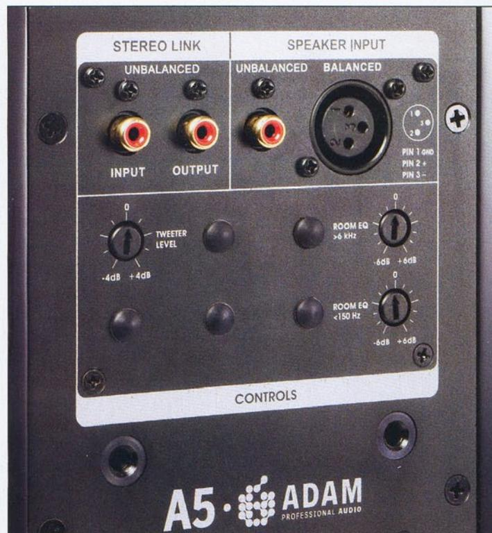
Fernbedienung: Die Signalschleife „Stereo Link“ regelt die zweite Box. Rechts daneben symmetrische und asymmetrische Eingänge. Die zahlreichen Filterregler helfen bei der Raumanpassung.
