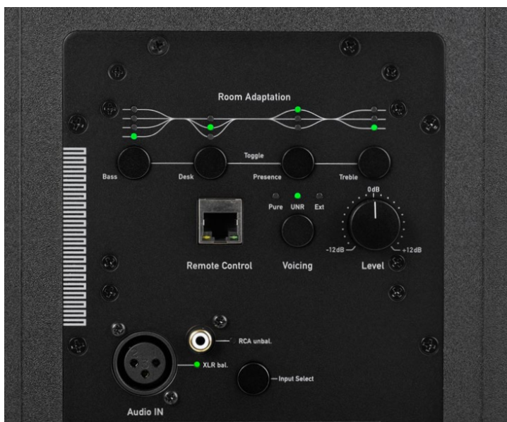
Am Lautsprecher selbst lassen sich vier Filterbänder einstellen und zwei ab Werk eingestellte Wiedergabepprofile „Pure“ und „UNR“ abrufen. Die Verbindung zur leistungsfähigen A Control-Steuerungssoftware erfolgt mittels der Ethernetbuchsen übers heimische Netzwerk.
