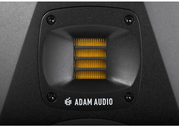
Das Markenzeichen für ADAM-Lautsprecher schlechthin und prägend für die Klangsignatur der Berliner: Der vorort von Hand gefertigte X-ART-Hochtöner, der dem Prinzip des „Air Motion Transformers“ folgt.
