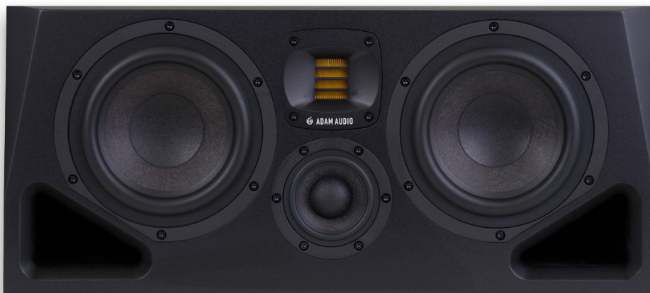
Zwecks Minimierung von Streuungseffekten sind die Kanten des MDF-Gehäuses abgeschrägt. Die Bassreflexöffnungen sind aus akustischen Gründen abgerundet. Tief- und Mitteltöner haben Membranen aus einem mehrschichtigen Mineralfasermaterial, dessen Stärke und Gestaltung individuell auf die jeweiligen Chassis zugeschnitten ist. Der HSP-Waveguide vor dem X-ART-Hochtöner lässt sich – beispielsweise für die optionale vertikale Aufstellung des Lautsprechers – um 90 oder 180 Grad drehen.
