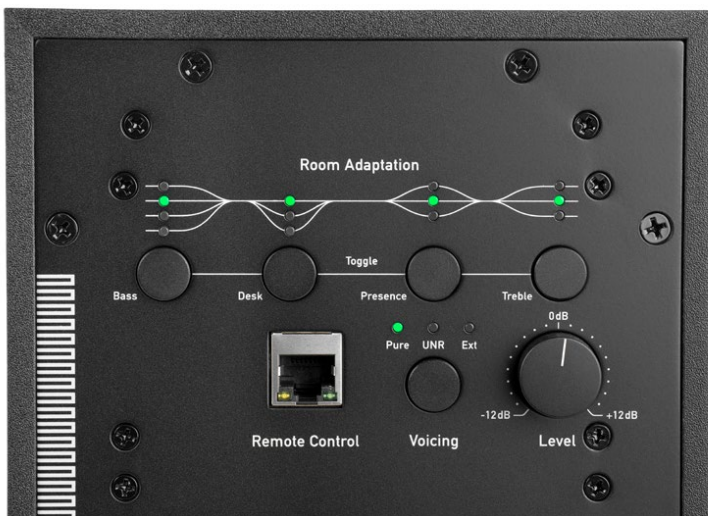
Der Raumanpassungsklangsteller in „Flat“-Einstellung. Außerdem ist das sogenannte „Pure“-Voicing ausgewählt, welches den A4V besonders signaltreu/neutral aufspielen lässt.
