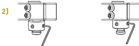
→ Stecken Sie das am Lautsprecher befestigte Montagezubehör auf die zylinderförmige Halterung **B**. Folgen Sie dabei den drei Schritten, die in den Abbildungen 3, 4 und 5 dargestellt sind.
