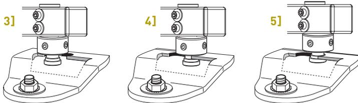
→ Lösen Sie die angezogene Innensechskantschraube [Abb. 6] und schieben Sie den Sicherungsring **E** wieder nach unten, bis er auf der Oberseite des Montagezubehörs aufliegt [Abb. 7].
