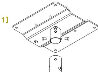
→ Setzen Sie die Teleskopstange **E** auf den Halterungsplattenzylinder **B** und sichern Sie es mit 4 der Linsenschrauben **C**. Ziehen Sie die Schrauben mit dem Sechskantschlüssel **H** an. Das Drehmoment sollte 15Nm betragen [Abb. 2 und Abb. 3].
