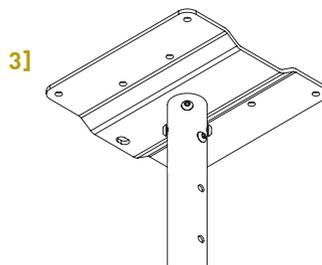
→ Stellen Sie die Höhe der Teleskopstange **E** ein und sichern Sie dessen inneren Teil. Nehmen Sie diese Einstellungen nur vor, solange kein weiteres Zubehör und kein Lautsprecher an der Deckenbefestigung befestigt sind.
