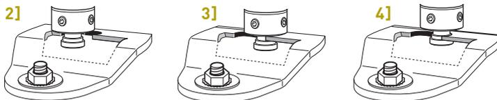
→ Lösen Sie den angezogenen Gewindestift **C** [Abb. 5] und schieben Sie den Sicherungsring **B** wieder nach unten, bis er auf der Oberseite des Montagezubehörs aufliegt [Abb. 6].
