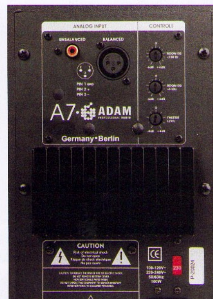
Mit den beiden Room-EQ-Reglern lässt sich der A7, falls erforderlich an den Abhörraum anpassen. Vorsicht ist beim Umgang mit dem dritten Regler, dem Tweeter Level geboten: Hiermit lässt sich der Pegel des Hochtöners beeinflussen, was sich drastisch auf das Klangbild auswirken kann.
